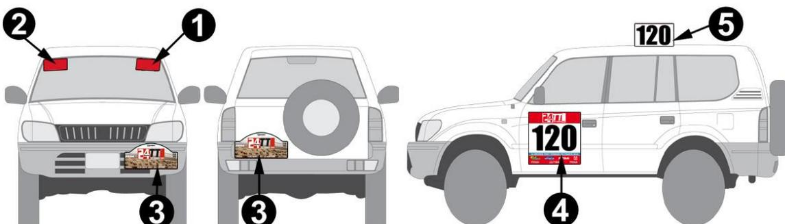
1. **un bandeau pare-brise** (25 x H10cm) : placé sur la partie supérieure du pare-brise côté pilote.
